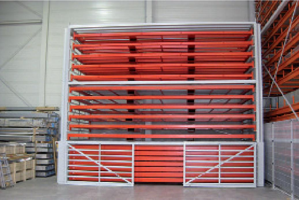
*Platzmangel, fehlende Sortierung und Ordnung – dieses Szenario gehört bei einem Hersteller von modularen Vorrichtungssystemen dank eines neuen Schubfachregals der Vergangenheit an. Mit Hilfe des speziell auf den Anwender zugeschnittenen Regals werden die vorher im Hof gelagerten Bleche nun geordnet direkt neben der Säge vorgehalten.*
