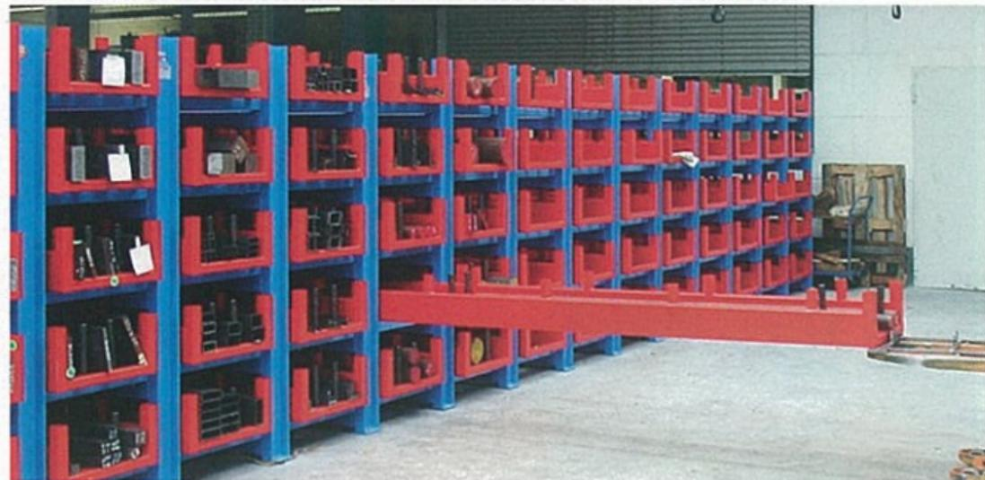
aus einem einsteckbaren Trägerpaar pro Fach, mit denen das nächste Grundregal verbunden ist. Das Wabenregal ist in mehreren Standardfarben wie zum Beispiel blau für den Rahmen und rot für die Kassetten erhältlich. Mit dem Ausrollbock werden die Kassetten an der Stirnseite aufgenommen, zirka 20 Millimeter hydraulisch angehoben und um ihre gesamte Nutzlänge herausgezogen. Das hintere Kassettenteil läuft dabei auf Spurkranzrädern.
