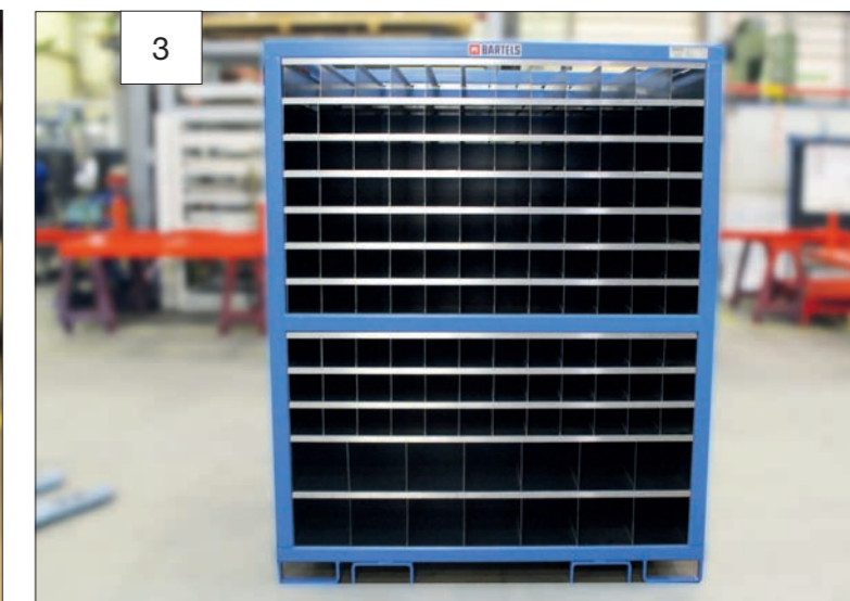
3. Ref.-Nr. 124.055.Z61 Wabenregal als Schweißkonstruktion Fachanzahl 134 Gesamttraglast 3618 kg
