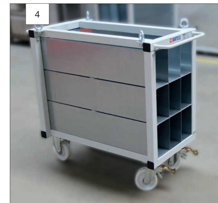
4. Ref.-Nr. 124.41.Z81 Fach B x H 143 x 215 mm Fachlänge 1000 mm Fachanzahl 3x3 Mit Rädern und angeschweißten Schubbügeln an den Stirnseiten Gesamttraglast 450 kg
