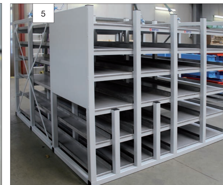
5. Ref.-Nr. 124.000.Z93 Wabenregal als Schweißkonstruktion Fachanzahl 28 Gesamttraglast 7500 kg
