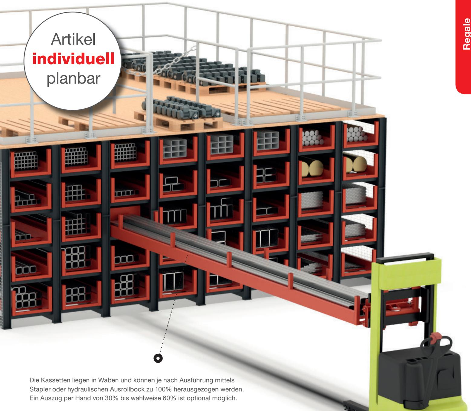
Die Kassetten liegen in Waben und können je nach Ausführung mittels Stapler oder hydraulischen Ausrollbock zu 100% herausgezogen werden. Ein Auszug per Hand von 30% bis wahlweise 60% ist optional möglich.
