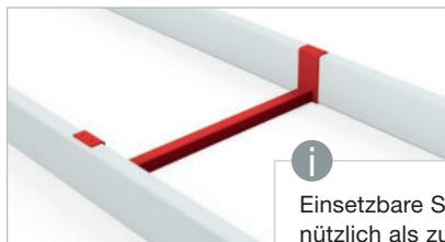
**i** Einsetzbare Stützen erhältlich. Sie sind nützlich als zusätzlicher Stützpunkt in der Kasette für weiches, zum Biegen neigendes Material.
