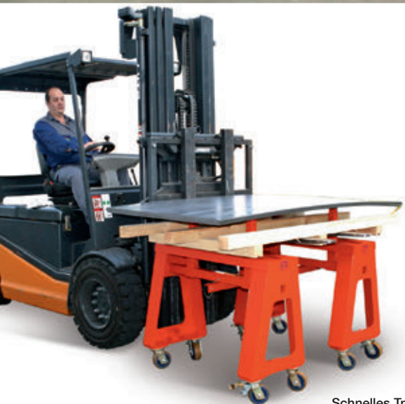
Schnelles Trennen von Blechpaketen und Paletten
